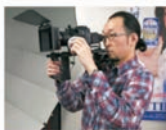
カビジョンロッドサポートシステム セッティング：ショルダーサポートベース、マンフロ ライディングベース、フォローフォーカス、リング ア (5種類)、マッドボックス100、ムービー
